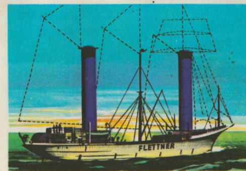
Cheminées sans fumée - Il n'est pas exclu qu'on réutilise un jour cette invention de l'ingénieur Flettner qui, en 1920, éprouva ce bateau à colonnes tournantes (rotors), valant un trois-mâts.
